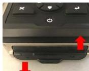
1. バッテリードアを開くため、ドアロックを反時計回りに回します。
