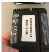
3. バッテリを装着するため、スロット接続部が左上に来るようになります。左の写真に示すように装置内に差し込むようにします。
