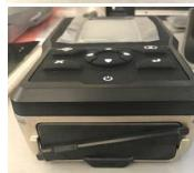
2. ロックを解除すると、ドアアセンブリが左の写真のように見えます。バッテリードアを外すとバッテリが見えます。
