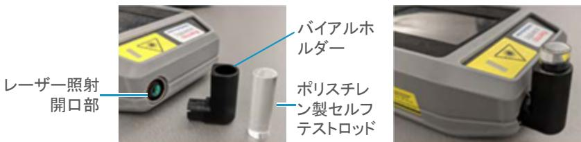
2. 上に示すように、ポリスチレン製ロッドをバイアルホルダーの中に入れます。ロッドをホルダーの奥までしっかりと押し入れ、レーザーが試料内に照射されるようにします。
