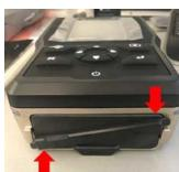
5. タブをバッテリの端部に沿わせて折り、バッテリードアを戻します。バーを時計回りに回してしっかりと閉じます。
