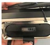
4. バッテリを取り付ける際は、写真に示すように、タブが外に出たままの状態であることを確認します。このタブを使うと、充電で交換が必要になったとき、簡単に取り外しできます。このタブの近くにあるインジケーターバーには、バッテリ残量が表示されます。
