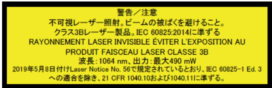
**レーザー開口部ラベル:**本開口部からレーザーのエネルギーが放射されるので、ご自身を含めて注意してください。照射により眼の損傷を招く可能性があります。
